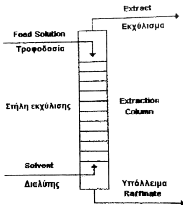
Εικόνα 22 Σχηματική παράσταση εκχύλισης (Πηγή: Σχεδιασμός Φυσικών Διεργασιών, Πανεπιστημιακές παραδόσεις του μαθήματος, Πασαδάκης Νικόλαος, Χανιά, 2008)
