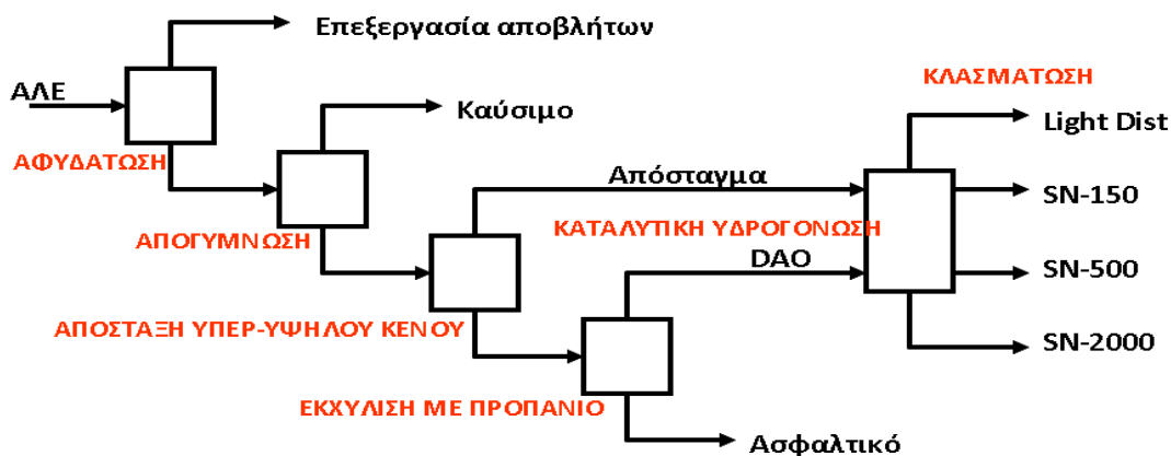
Εικόνα 7 Τεχνολογικό σχήμα αναγέννησης ορυκτελαίων διωλιστηρίου CYCLON (Πηγή: Ανάπτυξη καινοτόμου συστήματος βελτίωσης της ποιότητας των αναγεννημένων λιπαντικών-προϊόντων της εταιρείας CYCLON με χρήση αναλυτικών μεθοδολογιών και χημειομετρίας)
